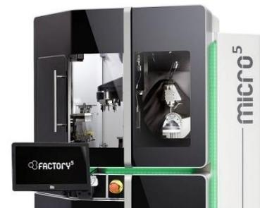
Finalement, les derniers composants pouvant être installés sur le banc de test sont des cloisons guillotines. Ces cloisons permettent de séparer la partie du centre d'usinage des autres parties de la machine comme le changement d'outil ou le changement de pièce. Cela permet d'éviter les projections de copeaux sur des parties sensibles de l'installation et donc d'éventuelles pannes.
